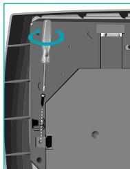
1. Verrouillez la trappe d'accès aux piles à l'aide de la petite vis cruciforme fournie dans le sachet d'accessoires.
