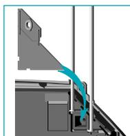
5. Glissez le guide-antennes sur les deux tubes d'antennes et placez un bouchon d'antenne sur chaque extrémité d'antenne.
