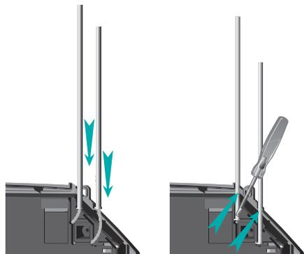
**3.** Vos antennes sont en place, bloquez-les dans cette position en plaçant le fixe-antennes triangulaire.
