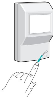
**6. Refermez le boîtier** du détecteur en engageant l'ergot bas puis en faisant pivoter le capot arrière jusqu'au "clac" de verrouillage.
