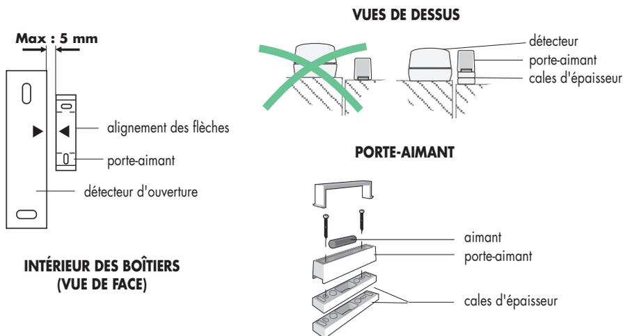
2. Fixez le fond du détecteur en utilisant les vis et les chevilles fournies ou une mieux adaptée si nécessaire.
