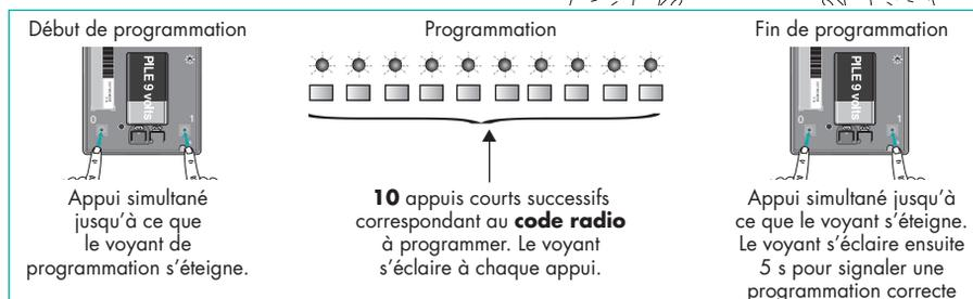
Exemple pour programmer le code 101110011 : après l'appui simultané du début de programmation, appuyez successivement sur 1, 0, 1, 1, 1, 1, 0, 0, 1, 1 et terminez par l'appui simultané de fin de programmation.
