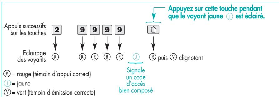
La centrale (en mode test) répond par une série de messages sonores à 2 tons du type : "Li.tut, Li.tut, Li.tut..." et éclaire son voyant Arrêt si le code radio personnalisé est correct. Vérifiez l'éclairage de ce voyant en réalisant à nouveau la procédure de vérification si nécessaire. S'il ne s'éclaire pas, reprenez la programmation du code radio personnalisé.
