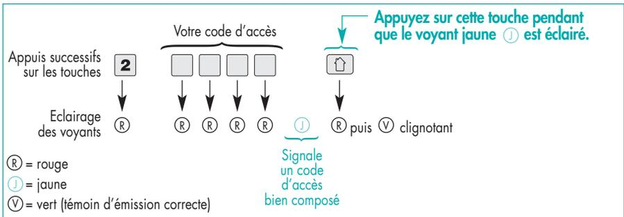
La programmation du code d'accès est correcte si le voyant jaune Ⓜ s'éclaire. Vérifiez l'éclairage de ce voyant en réalisant à nouveau la procédure de vérification si nécessaire. Si le voyant jaune Ⓜ ne s'éclaire pas, reprenez la programmation du code d'accès.
